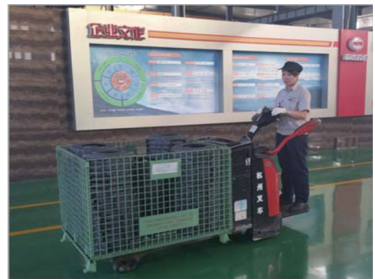
生产过程中使用电动叉车运送物料，减少废气的排放
